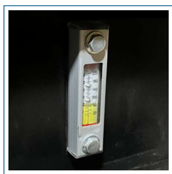
Medidor de combustible
