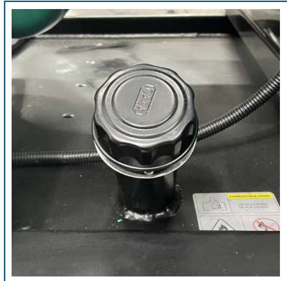
Tanque de combustible
